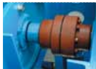
SCD-Direktantrieb – verlustfreie Kraftübertragung
