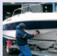
Exzenterschleifer 170 l/min, 6-7 bar
